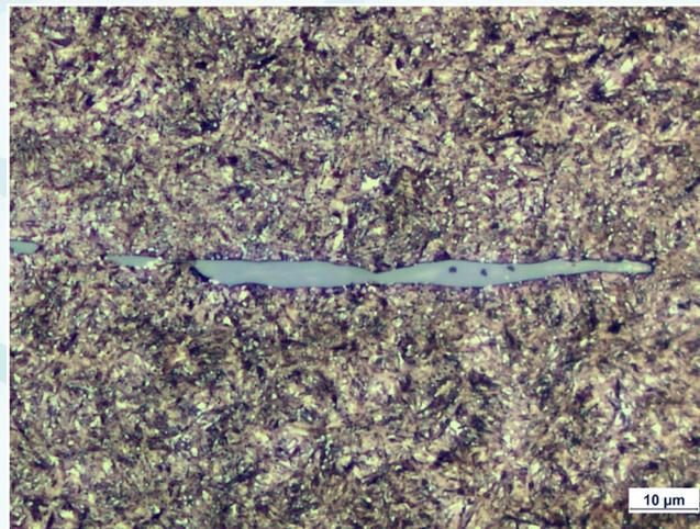
Tool Steel 100MnCrW4+QT, 700 HV, longitudinal section
